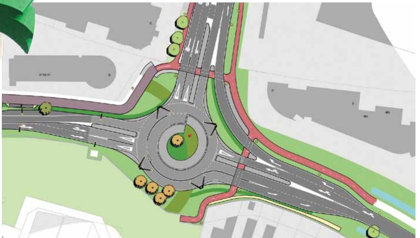
Overzicht van de nieuwe turborotonde bij de aansluiting op de Zuidelijke Randweg - De Vest
